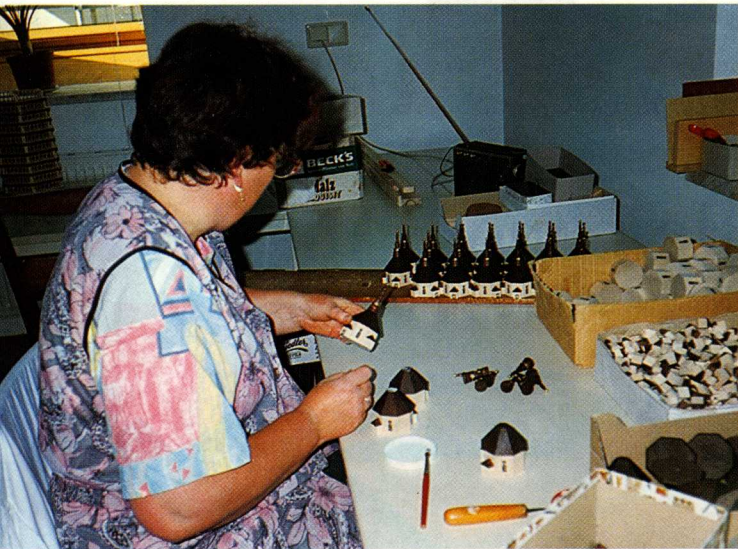
Links • Vier vorgefertigte Bauteile werden bei der Dorfkirche benötigt. In den Kartons liegen sie: Hauptteil der Kirche, Seitenkapellen, Dach und Turm. Das Unterteil und die Seitenstücke bestehen aus Ahorn, für das Dach wird Esche gebeizt genommen. Die gedrechselte Turmspitze besteht aus gebeizter Buche, die mit Goldbronze vergoldet wurde.
