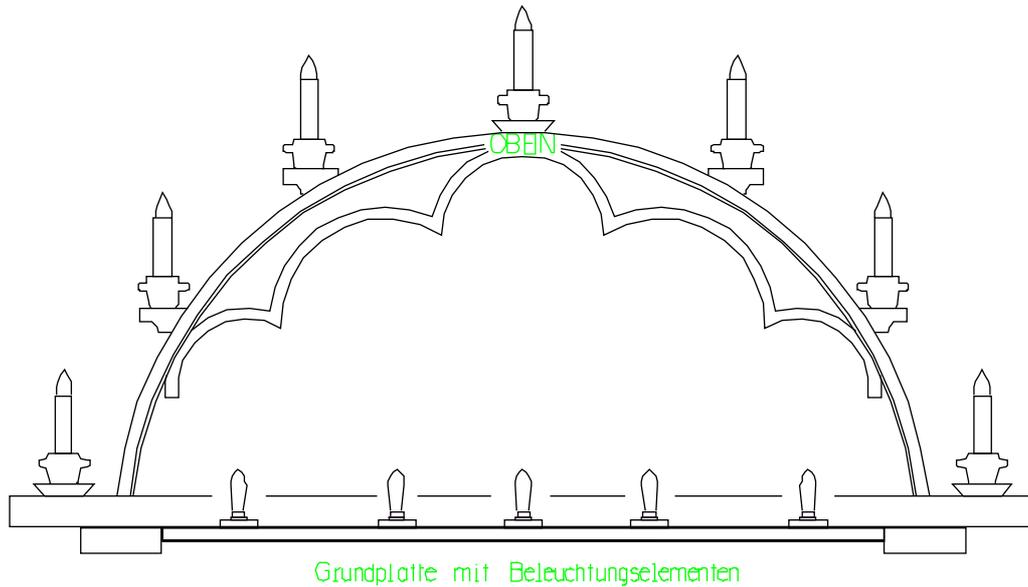
2. **Netzstecker ziehen!** Schrauben am Unterboden lösen und Grundplatte mit montierten Beleuchtungselementen **vorsichtig** nach unten herausdrehen. Unterer Teil der Grundplatte bleibt zwischen den Fußplatten.
